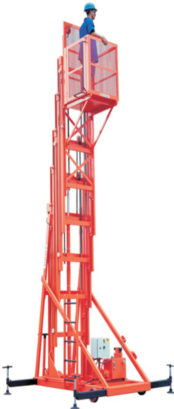
ELEVADOR DE MANUTENÇÃO
